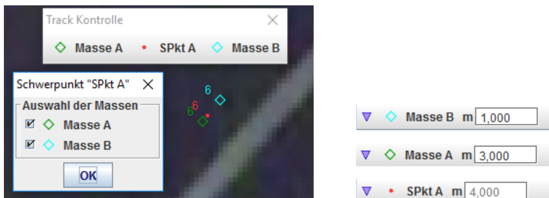
a) Definition und Position des Schwerpunktes SPkt A (Rot)
